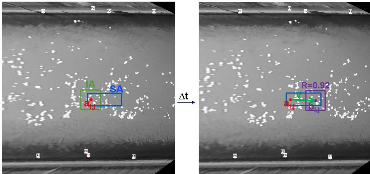
La précision du calcul étant au pixel près, il est intéressant de réaliser une interpolation sub-pixel. Soit  $b_{i,j}$  la position du maximum de corrélation. Dans **Fudaa-LSPIV**, un ajustement d'une loi Gaussienne unidimensionnelle est utilisé sur les axes i et j pour obtenir une précision de déplacement de l'ordre de 0,2 pixels sous la forme :
