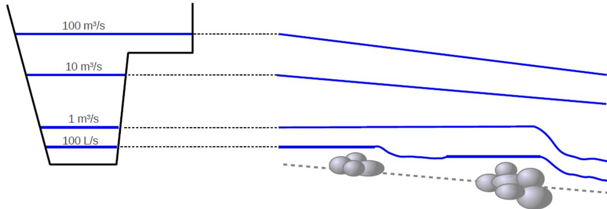
$$Q(h) = \begin{cases} 0 & \text{si } h < k_1 \\ a_1(h - b_1)^{c_1} & \text{si } k_1 \leq h < k_2 \\ a_2(h - b_2)^{c_2} & \text{si } k_2 \leq h < k_3 \\ a_3(h - b_3)^{c_3} & \text{si } k_3 \leq h < k_4 \\ a_3(h - b_3)^{c_3} + a_4(h - b_4)^{c_4} & \text{si } k_4 \leq h \end{cases}$$
